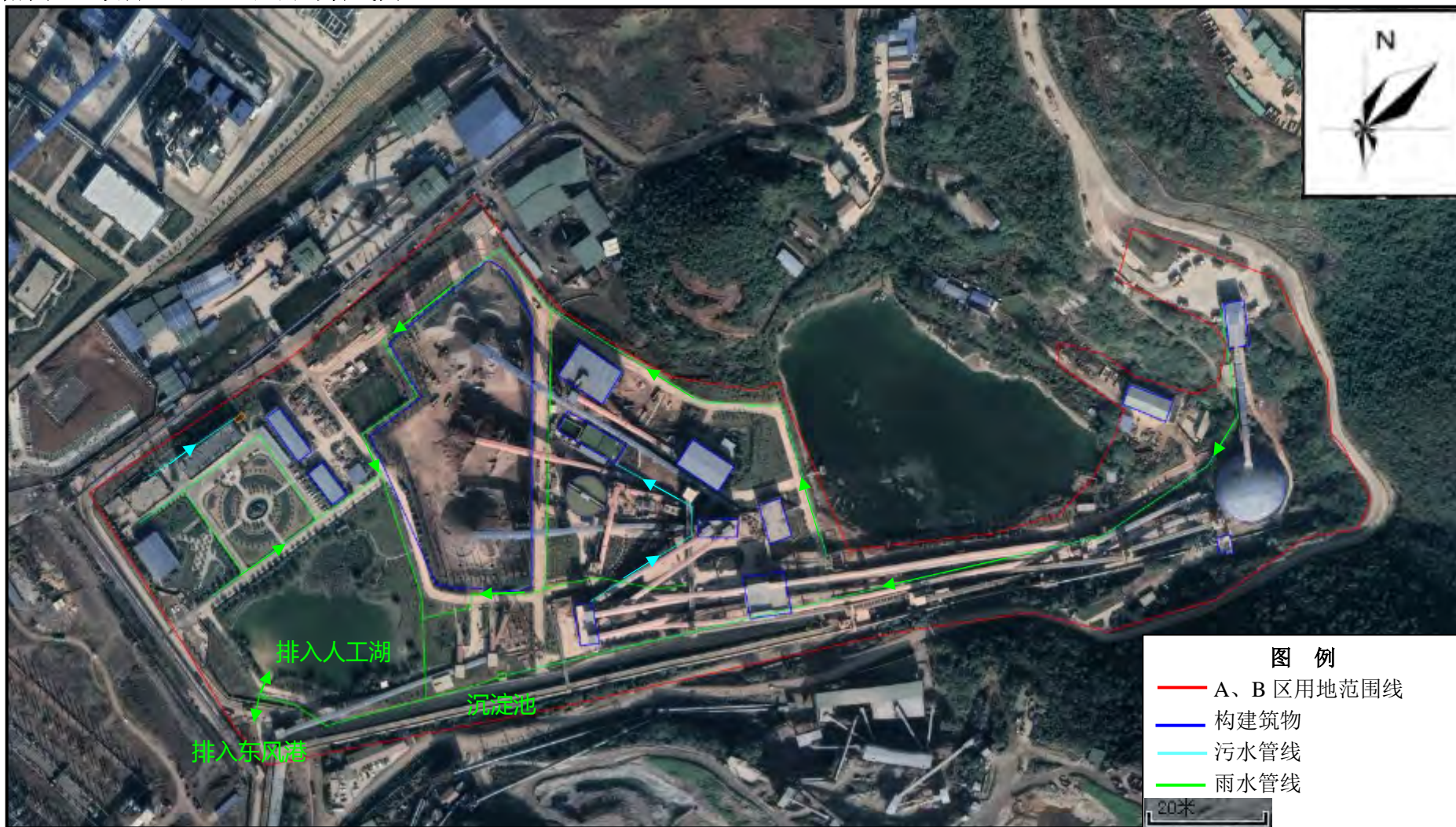
附图 6: 项目 A 区、B 区雨污管线图
